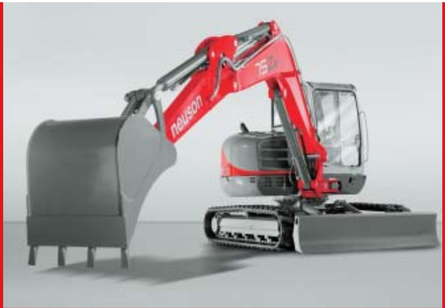
Die Fahrtriebe der neuen Baureihe verfügen nun über ein „automatic power-shift“ Getriebe. Der Fahrtrieb ist damit grundsätzlich im 2. Gang – also auf Schnellfahrt – geschaltet und legt bei erhöhtem Kraftbedarf automatisch den 1. Gang ein. Beim Planieren erfolgt also die Retourfahrt automatisch „schnell“. Der 2. Gang kann aber auch mittels Schalter am Armaturenbrett gesperrt werden.
